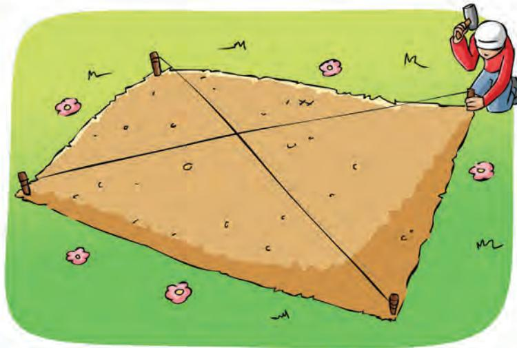
Los jardineros, al igual que los albañiles, utilizan un cordel bien estirado y amarrado a dos estacas para que les sirva de guía al hacer trabajos en línea recta.
