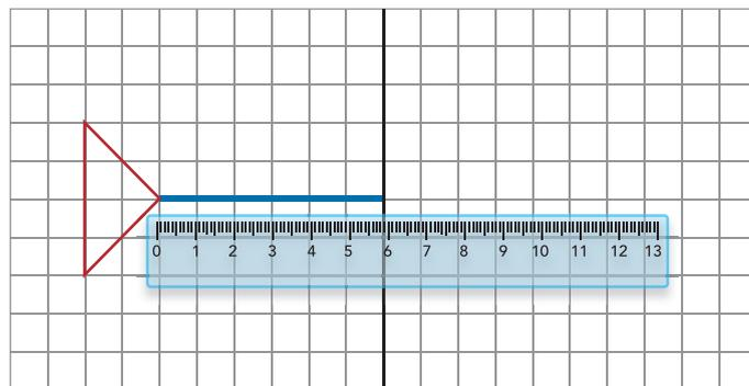
3. Esta misma longitud se prolonga sobre la línea horizontal a partir del eje de simetría, pero en el lado contrario del plano. Allí se tiene el punto simétrico.
